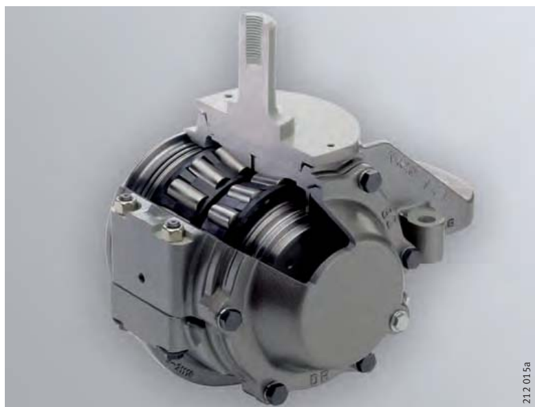
Рисунок 5 Подшипниковые узлы с коническими роликоподшипниками для пассажирских вагонов
