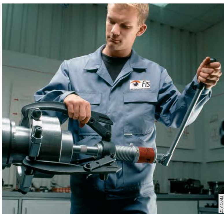
Рисунок 1 Демонтаж подшипника с помощью гидравлического съемника
