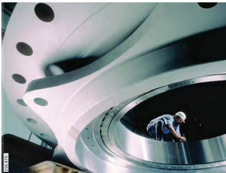
Рисунок 5 Монтаж крупногабаритного подшипника качения
